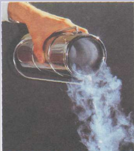
Сосуд Дьюара для хранения жидкого азота
